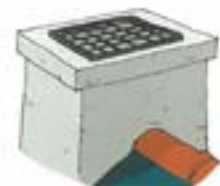
Couvrir le faîtage d'une solide grille.
