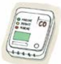
Installer un détecteur mixte de fumées et monoxyde de carbone.
